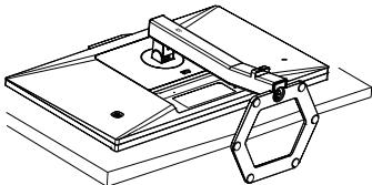
2. Нажав кнопку фиксатора, наклоните основание и извлеките его.
