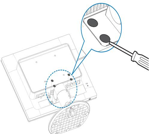
3. Ta bort skruvarna från gängjärnslocket.
