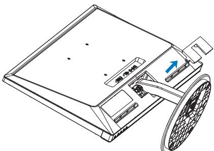
4. Solte os quatro parafusos para remover a coluna.
