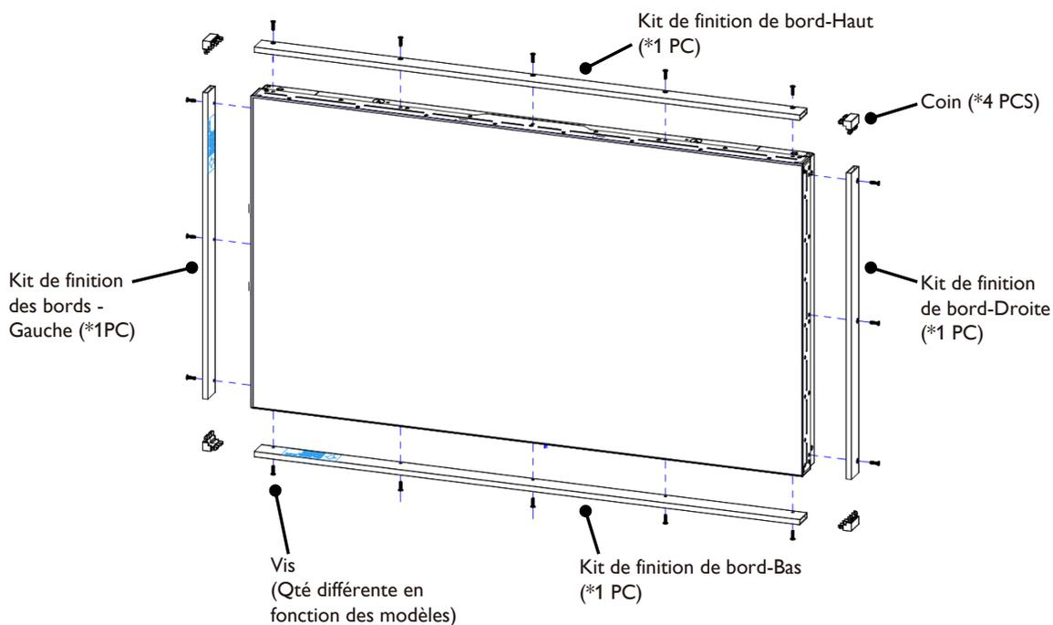
Installer le kit de finition des bords pour une configuration d'écran 2x2
