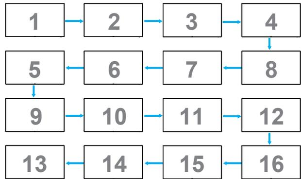
**Remarque :** Pour utiliser cette fonction, connectez toutes les machines en série avec des câbles RS-232 et configurez aussi leurs ports de contrôle réseau sur RS-232.
