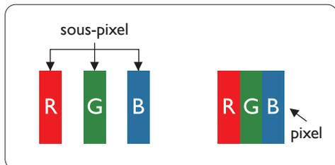
Un pixel, ou un point d'une image, est composé de trois sous-pixels avec les couleurs basiques rouge, vert et bleu. Une image se compose d'un grand nombre de pixels. Lorsque tous les sous-pixels d'un pixel sont allumés, les trois couleurs ensemble apparaissent comme un pixel blanc. Lorsque tous les sous-pixels sont éteints, les trois sous-pixels ensemble apparaissent comme un pixel noir. D'autres combinaison de sous-pixels allumés et éteints permettent de créer des pixels d'autres couleurs.
