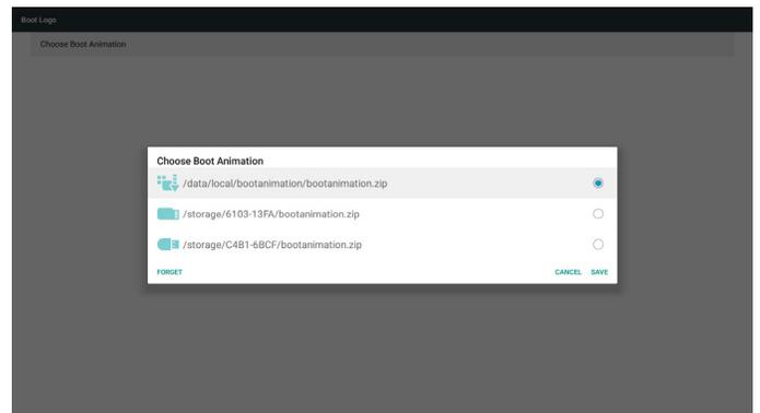
3) Si el elemento del logotipo del menú OSD está establecido en Encend o Apagad, no se puede seleccionar la animación de arranque en la configuración de Android.
