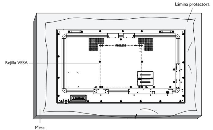
1. Prepare una superficie plana y horizontal que sea más grande que la pantalla y extienda una lámina protectora sobre la misma para simplificar el procedimiento sin arañar la pantalla.
