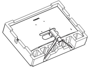
2. Quite la tapa de la bisagra del cuerpo del monitor con una herramienta auxiliar.
