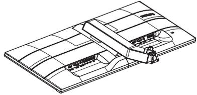
2. Ziehen Sie die Schraube an der Unterseite der Basis mit Ihren Fingern fest; bringen Sie die Basis sicher am Ständer an.
