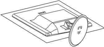
2. Drücken Sie zum Entfernen der Basis von der Basissäule die Freigabeclips zusammen.
