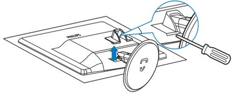
2. Lösen Sie die vier Schrauben, nehmen Sie die Basis anschließend vom Monitor ab.
