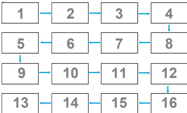
**Nota:** Per utilizzare questa funzione, eseguire il collegamento seriale di tutte le macchine utilizzando il cavo RS-232 ed impostare su RS-232 la relativa porta di controllo di rete.
