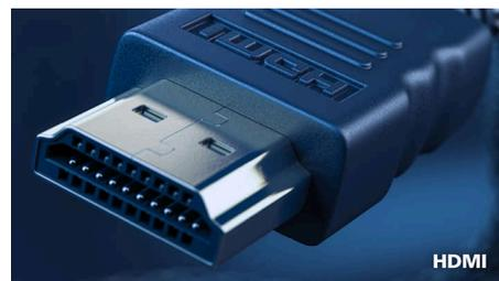
Un dispositivo HDMI-Ready dispone di tutto l'hardware necessario per accogliere un ingresso High-Definition Multimedia Interface (HDMI). Un cavo HDMI consente segnali audio e video digitali di alta qualità trasmessi su un singolo cavo da un PC o un qualsiasi numero di sorgenti AV (tra cui decoder, lettori DVD, ricevitori A/V e videocamere).
