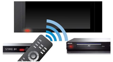
EasyLink 使用 HDMI CEC 業界標準協定來控制已連接裝置和電視透過 EasyLink，只需一個遙控便可以使用電視和已連接裝置的主要功能。EasyLink 使用標準的 HDMI 電線傳輸系統命令，它在所有配備有 HDMI CEC 的電子裝置之間工作。
