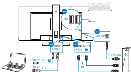
3. OSD 메뉴로 들어갑니다. KVM 계층으로 이동해서 "자동", "USB C" 또는 "USB up" 을 선택해서 한 장치에서 다른 장치로 주변장치 제어를 전환합니다. 주변장치 한 세트를 사용해서 제어 시스템 간에 전환하려면 이 단계를 반복하십시오.
