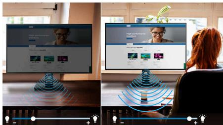
PowerSensor je ugrađeni senzor za prepoznavanje korisnika koji odašilje i prima infracrvene signale koji nisu štetni radi određivanja nalazi li se korisnik ispred monitora te omogućava automatsko smanjenje svjetline monitora kada se korisnik udalji od stola, čime se troškovi za energiju smanjuju za do 70 posto i produžuje vijek trajanja monitora.
