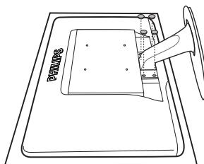
2. Remova os 4 parafusos e depois separe a base do monitor.
