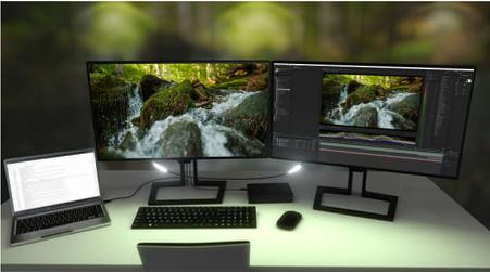
La conexión en cadena te permite controlar varios monitores y dispositivos desde un único puerto Thunderbolt de tu portátil. Conecta este monitor desde el puerto Thunderbolt de tu portátil y, a continuación, desde el segundo puerto Thunderbolt de este monitor puedes conectar un segundo monitor 4K.
