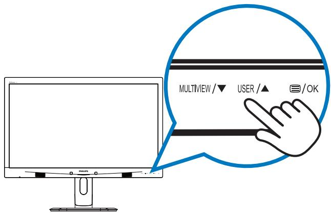
Na primer, če ste izbrali [**Audio Source (Vir zvoka)**] kot bližnjično tipko, pritisnite gumb **USER** na sprednji plošči in pojavit se bo meni [**Audio Source (Vir zvoka)**].
