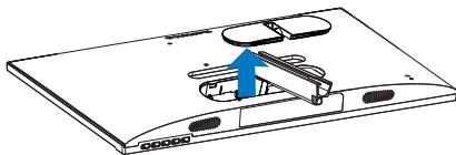
4. Викрутіть гвинти з тримача за допомогою викрутки та від'єднайте тримач/підставку від монітора.
