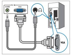
A conexão através do VGA requer um cabo de áudio adicional.
