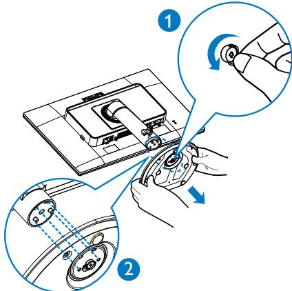
3. Удерживая нажатой кнопку фиксатора, наклоните основание и выдвиньте его.
