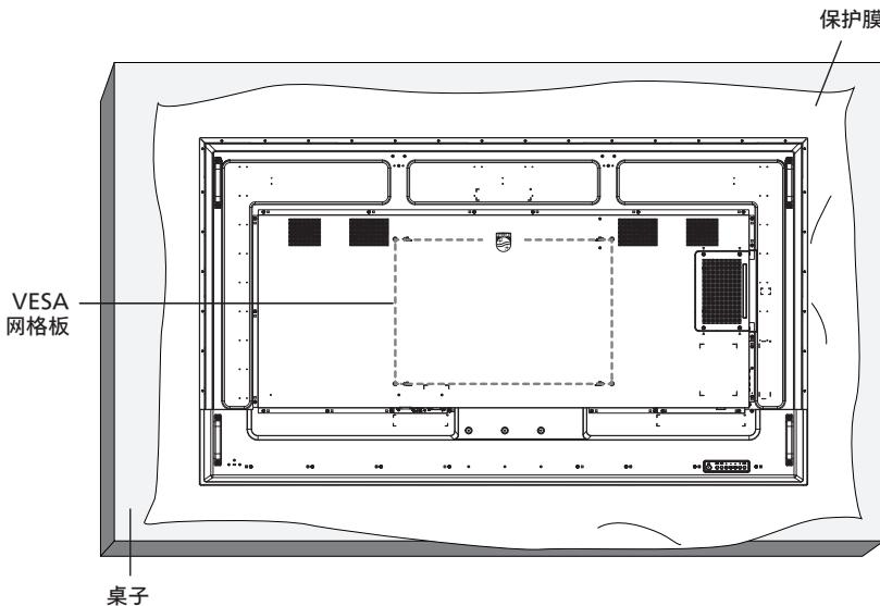
1. 将在平坦表面上包装显示器时在其周围包裹的保护膜展开。将显示器面朝下放在保护膜上，以便于操作而不会刮伤屏幕。
