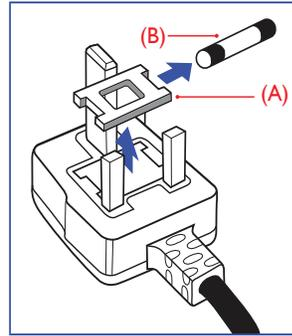
Cet appareil est fourni avec une prise moulée approuvée 13A. Pour changer un fusible dans ce type de prise, procédez comme suit :
