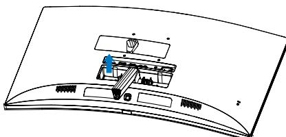
4. Pomoću odvijača uklonite vijke na nosaču, a zatim uklonite nosač/postolje sa monitora.
