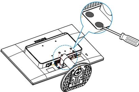
3. Entfernen Sie die Schrauben von der Gelenkabdeckung.
