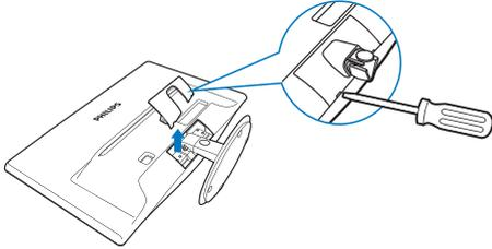
2. Remova 4 parafusos e depois remova a base do monitor.
