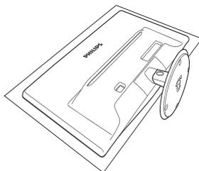
2. Pressione as patilhas de bloqueio para retirar a base da coluna de suporte.
