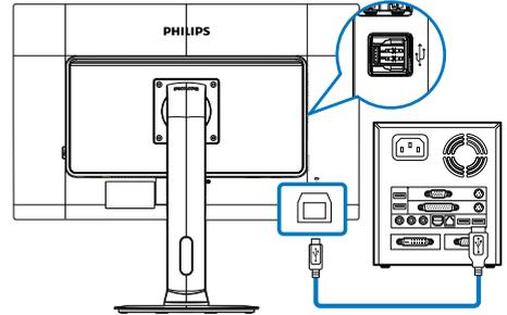
1. Collegare il cavo USB all'upstream USB dell'hub USB sul lato IO del monitor dal lato PC.
