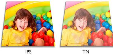
I display IPS utilizzano una tecnologia avanzata che offre un angolo visuale estremamente ampio di 178/178 gradi, rendendo possibile la visualizzazione da qualsiasi angolazione, anche in modalità di rotazione di 90°. A differenza dei pannelli TN standard, i display IPS garantiscono immagini davvero nitide dai colori naturali, così da renderli ideali non solo per foto, film e navigazione in rete, ma anche per quelle applicazioni professionali che richiedono colori accurati e costante luminosità.
