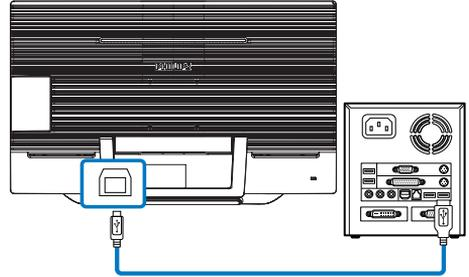
1. Schließen Sie den PC per USB-Kabel an den Upstream-Anschluss des USB-Hubs an der Unterseite des Monitors an.
