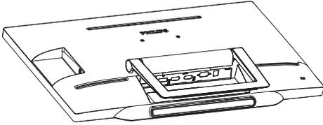
2. Drücken Sie die Scharnierabdeckung etwas mit den Fingern zusammen, bis sich der Haken aus dem Schlitz löst.
