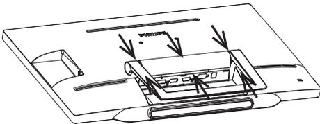
3. Lösen Sie die vier Schrauben mit einem Schraubendreher.
