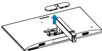
4. 使用螺丝刀卸下支撑臂上的螺丝，然后从显示器分离支撑臂 / 支架。
