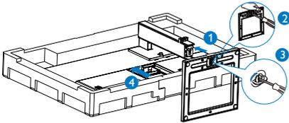
3. Når du har festet basen, må du montere skjermen mens begge hender holde skjermen godt sammen med styropor. Nå kan du trekke ut styroporen. Når du trekker ut styroporen, må du ikke klemme panelet for å unngå at det blir ødelagt.
