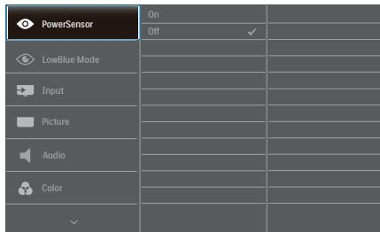
コントロールキーの基本および簡単な指示上に示したOSDで、モニタの前面ベゼルの▼▲ボタンを押してカーソルを動かしたり、OKボタンを押して選択または変更を確認できます。
