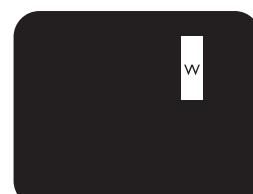
Tre tilstøtende belyste underpiksler (en hvit piksel).
