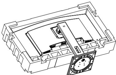
2. Нажав кнопку фиксатора, наклоните стойка и извлеките его.
