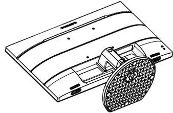
2. Presione los broches de bloqueo para desmontar la base de la col.
