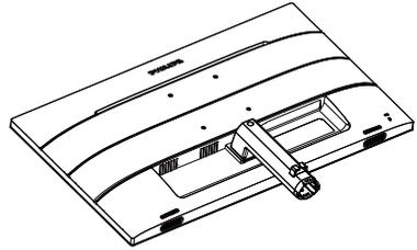
2. Sujete el soporte de la base con ambas manos e inserte firmemente el soporte de la base en la columna de la misma.
