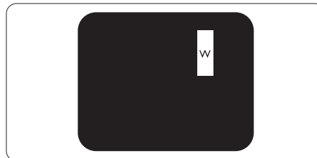
Tri susjedna svijetla podpiksela (jedan bijeli piksel).
