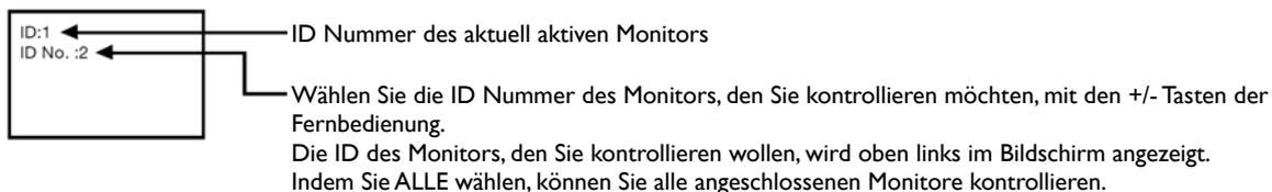
4. Richten Sie die Fernbedienung auf den Fernbedienungs-Signalsensor des PRIMÄREN Monitors. Das OSD erscheint auf dem Monitor und zeigt die ID Nummern, die Sie ausgewählt haben.
