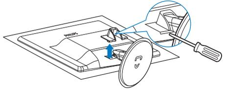
2. Remova 4 parafusos e depois remova a base do monitor:
