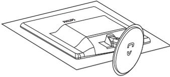
2. Pressione as patilhas de bloqueio para retirar a base da coluna de suporte.
