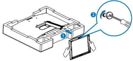
3. 安裝上基座後，用雙手直立顯示器以一起固定顯示器和保麗龍。現在您即可拉出保麗龍。請注意本顯示器採曲線彎曲設計，當您拉出保麗龍時，請勿擠壓面板以免面板受損。
