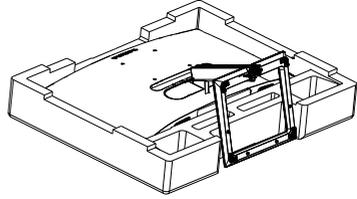
2. 用螺絲刀鬆開底座底部的螺絲，並取出底座中的基座。
