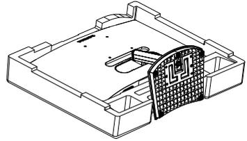
2. (1) 用螺絲刀鬆開底座底部的螺絲。
