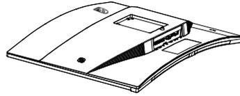
2. Segure o suporte com ambas as mãos. Coloque cuidadosamente o suporte na área de montagem VESA até que o trinco fixe no suporte.
