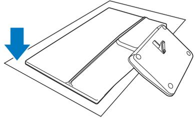
2. Halten Sie Bildschirm und Basis mit beiden Händen. Klappen Sie die Basis vorsichtig vertikal in einem festen Winkel nach unten.
