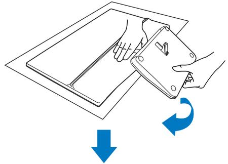
3. Biegen Sie die Basis zum Festhalten des Monitors vertikal nach oben.
