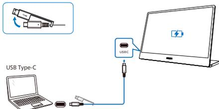
2. ノートパソコンのUSB-AポートとモニターをUSB A-Cケーブルで接続します。(電子マーク付きケーブル、定格電流:5A)
