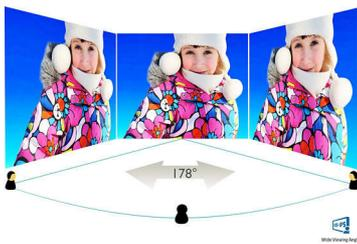
В IPS-ADS-дисплеях используется прогрессивная технология, обеспечивающая широкий угол обзора 178/178 градусов для просмотра дисплея практически под любым углом. По сравнению со стандартными TN-панелями IPS-ADS-дисплеи обеспечивают значительно более высокую четкость изображения и яркие цвета, что делает их идеальным решением не только для просмотра фотографий, фильмов и веб-сайтов, но также и для работы в профессиональных приложениях, где требуется точная передача цвета и яркости.
