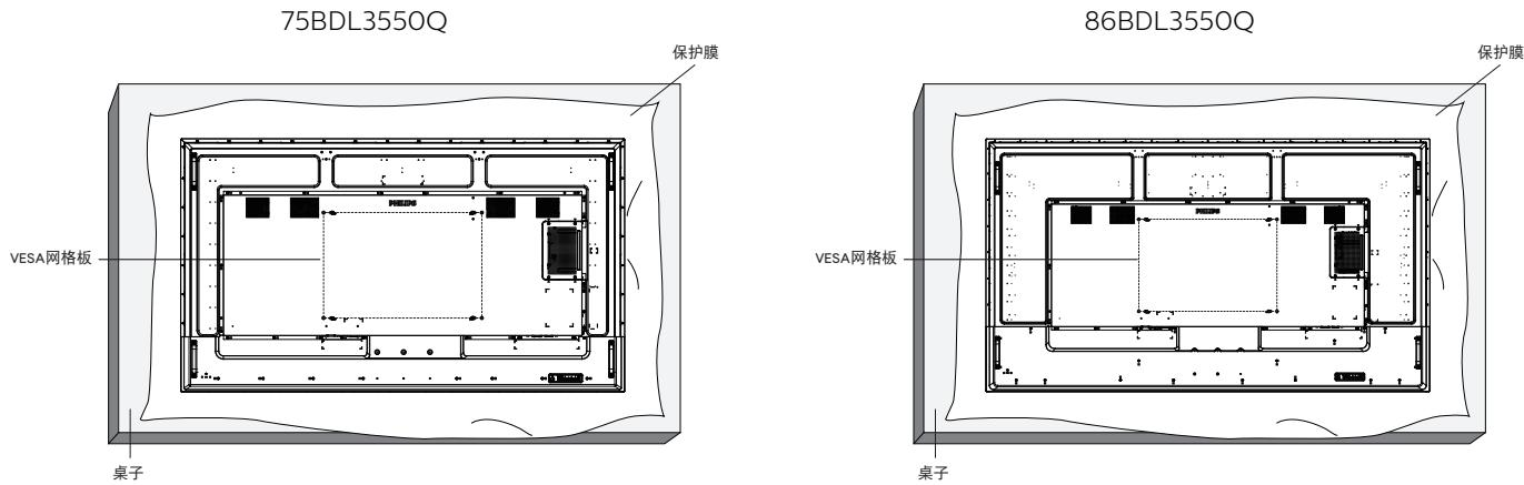
1. 将在平坦表面上包装显示器时在其周围包裹的保护膜展开。将显示器面朝下放在保护膜上，以便于操作而不会刮伤屏幕。
