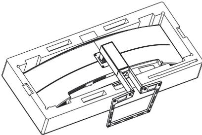
2. Lösen Sie die Montageschrauben, und trennen Sie dann die Halterung vom Monitor.
