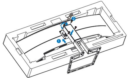
3. Richten Sie den Monitor nach Anbringung der Basis auf, indem Sie ihn mit beiden Händen sicher gemeinsam mit dem Styropor greifen. Nun können Sie das Styropor herausziehen. Beachten Sie, dass dieser Monitor ein gewölbtes Design besitzt. Drücken Sie den Bildschirm beim Herausziehen des Styropors nicht zusammen. Andernfalls könnte er beschädigt werden.
