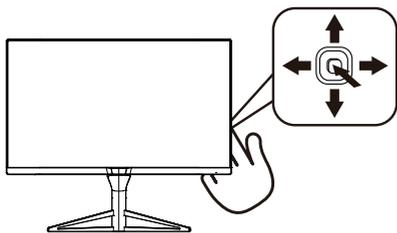
1. Přepnutím doleva spustíte funkci SmartImage v nabídce na obrazovce.
