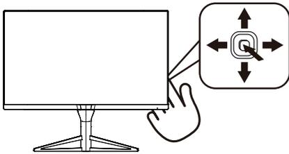
Chcete-li na tomto displeji Philips vyvolat OSD nabídku, jednoduše použijte přepínací tlačítko na spodní straně rámečku monitoru. Jednoduché tlačítko funguje jako joystick. K přesouvání kurzoru prostě přepínejte ovladač čtyřmi směry. Po stisknutí tlačítka lze vybrat požadovanou možnost.
