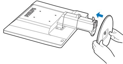
3. 将显示器底座支撑臂装到底座支撑柱上，固定底座支撑臂。
