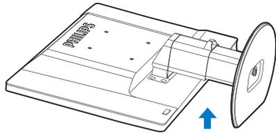
3. 松开底座支撑臂锁，从底座支撑柱上卸下底座支撑臂。
