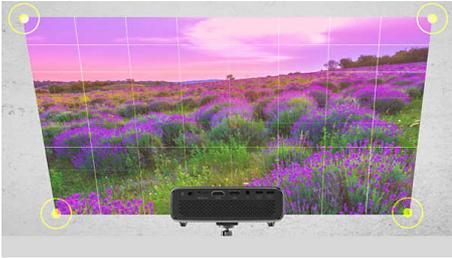
Messa a fuoco automatica, zoom digitale e correzione Keystone automatica per garantire l'immagine migliore ovunque la si proietti. Il modello PicoPix Max si regola automaticamente per una proiezione chiara e perfettamente angolata, indipendentemente dalla superficie.
