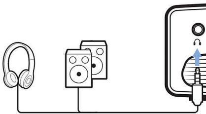
Verbinden Sie Kopfhörer oder Lautsprecher mit externer Stromversorgung über die integrierte 3,5-mm-Buchse.
