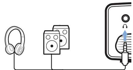
Ligue quaisquer auscultadores ou colunas externas com alimentação própria através da tomada de 3,5 mm integrada.
