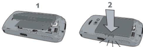
Установите заднюю панель, как показано ниже; вставьте переднюю панель в проушины в верхней части телефона, затем надавите на нижнюю часть до срабатывания защелки.
