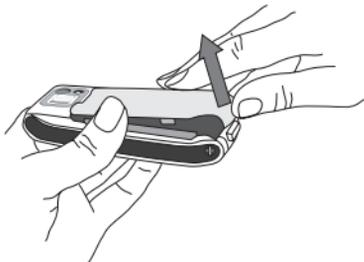
若要將電池取出，依圖中所示方向提起電池。
