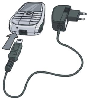
電池符號可指示充電的狀態。在充電期間，4 格電力指示符號會持續波動；使用標準充電器時，一個完全沒電的電池最長需要 3 小時才能充滿。當 4 個指示格都穩定不變時，表示電池已完全充滿電。然後您可將充電器拔除。根據系統及使用狀況而定，通話時間可長達 4 個小時，而待機時間可長達 300 個小時。
