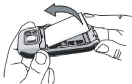
如果您的 SIM 卡是隨一張信用卡大小的卡片提供給您的，請先從該卡中折取出 SIM 卡，然後置入手機的金屬彈簧夾下方，直到它停止不動為止。請確保 SIM 卡的切角位置正確，同時金色接觸面朝下。
