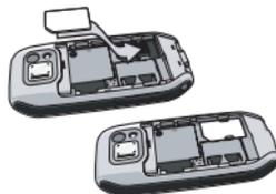
將電池推入電池槽內，直到它停止不動為止，金屬接觸面要朝下。然後，將電池壓下，將它鎖定位置。
