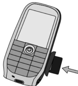
如果要移除迷你 SD 卡，將卡片推入卡槽再放開。該卡片將會從卡槽中彈出。
